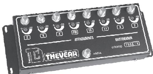
Os misturadores códigos 1050-E, 1050-EU e 1055-F são aparelhos utilizados em instalações coletivas, onde se deseja "somar", canais de diferentes frequências e origens, em uma única saída, ou seja, em um único cabo. O misturador cód. 1050-E possui 8 entradas e uma saída, sendo sete entradas para canais de TV e uma entrada para FM (3 canais na banda I, 1 entrada para FM e 4 canais na banda III).
